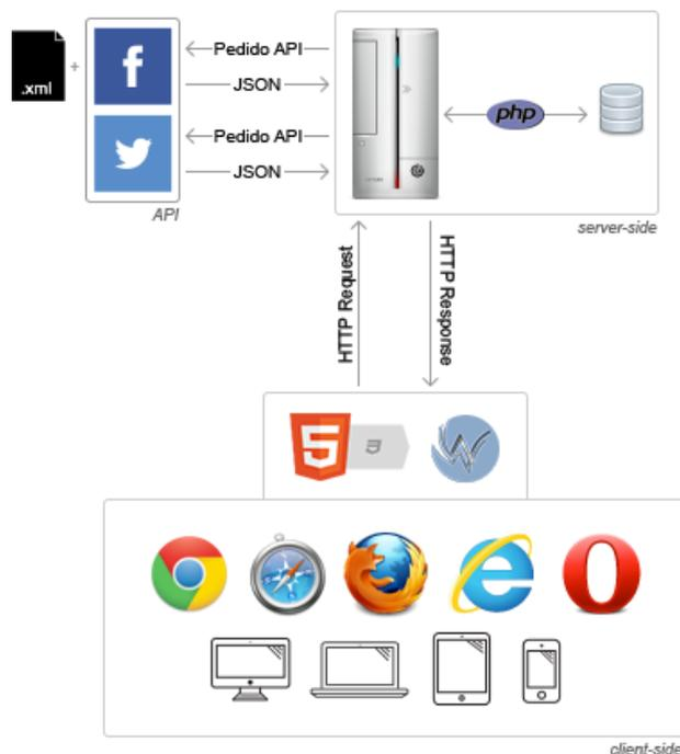
Figura 10 – Arquitetura de sistema da aplicação
